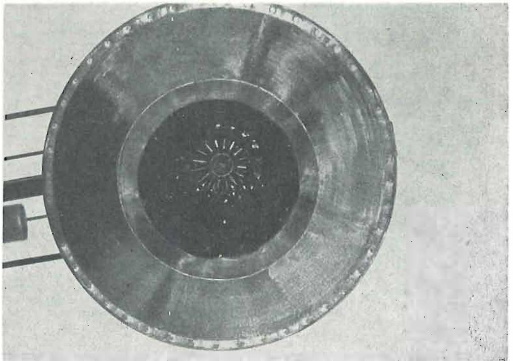
*Caldaia solare per il riscaldamento di gas ad alta temperatura (> 800°C). Realizzato dall'Università di Genova (prof. Francia) nel SPES-CNR.*
